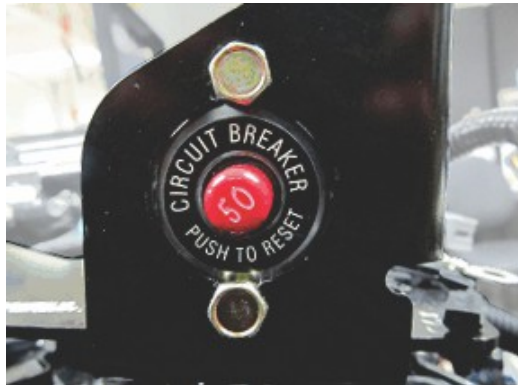
Motorda bulunan motor kablo tesisatı ve aygıt devre kesicisi
