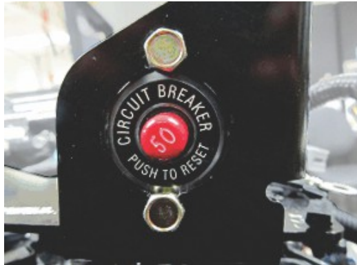
Motor kablo tesisatı ve aygıt devre kesici
