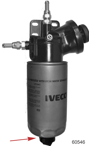
WIF sensörü. Mekanik pompa gösterilmiştir; diğerleri de benzerdir.
