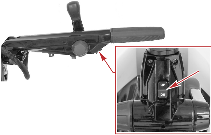
Yeke üzerinde yatırma düğmesi olan modeller
